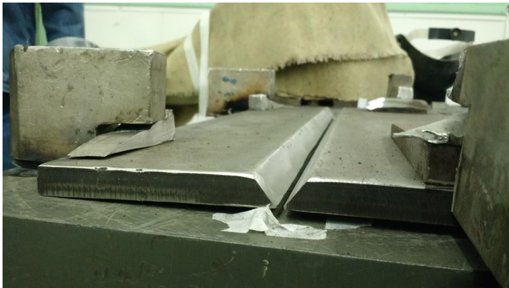
Figura 21: Placas posicionadas para o processo de soldagem.
