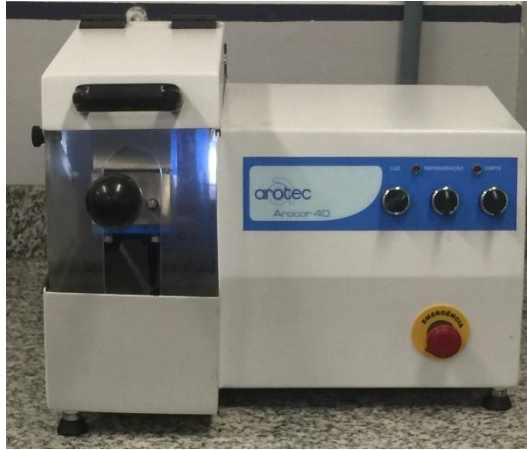
Figura 24: Serra circular Laboratório de metalurgia do CEFET/RJ Itaguaí - Arotec Arocor 40.
