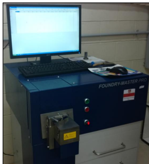
Figura 25: Espectrômetro de emissão óptica por centelha pertencente ao Laboratório de Caracterização Microestrutural do Exército Brasileiro.
