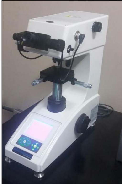
Figura 34: Microdurômetro Vickers/Knoop Instron-Wilson EDS pertencente ao CEFET- RJ Campus Maracanã.
