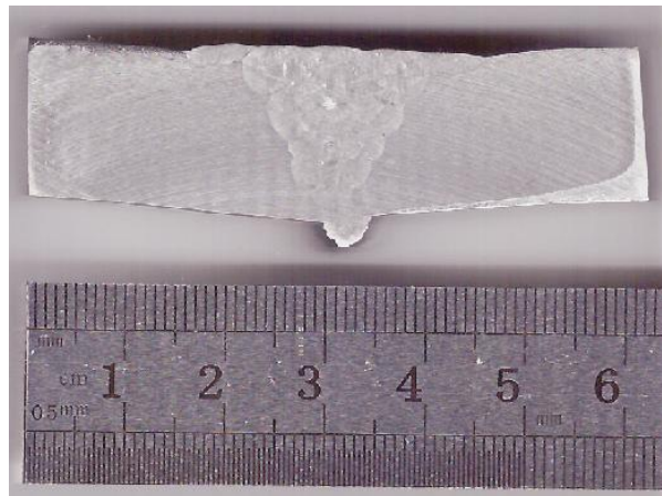
Figura 36: Macrografia da junta Soltada pelo processo GTAW. Ataque: Ácido oxálico 10%.
