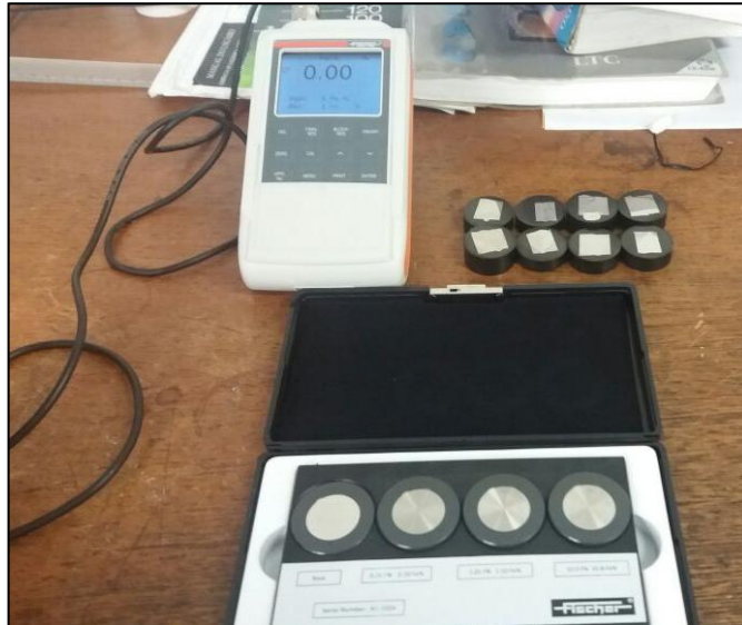
Figura 28: Ferritoscópio Helmut Fisher FMP30 cedido pela Nuclebrás Equipamentos Pesados - NUCLEP.
