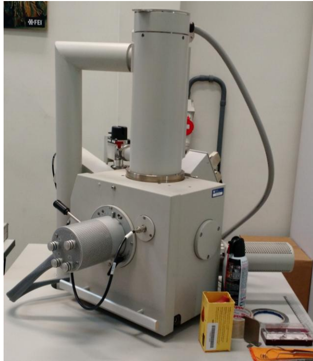
Figura 26: Microscopia Eletrônica de Varredura(MEV) Espectroscopia por Dispersão de Energia (EDS)- FEI modelo Inspect S50 - pertencentes ao Instituto Nacional de Tecnologia (INT).
